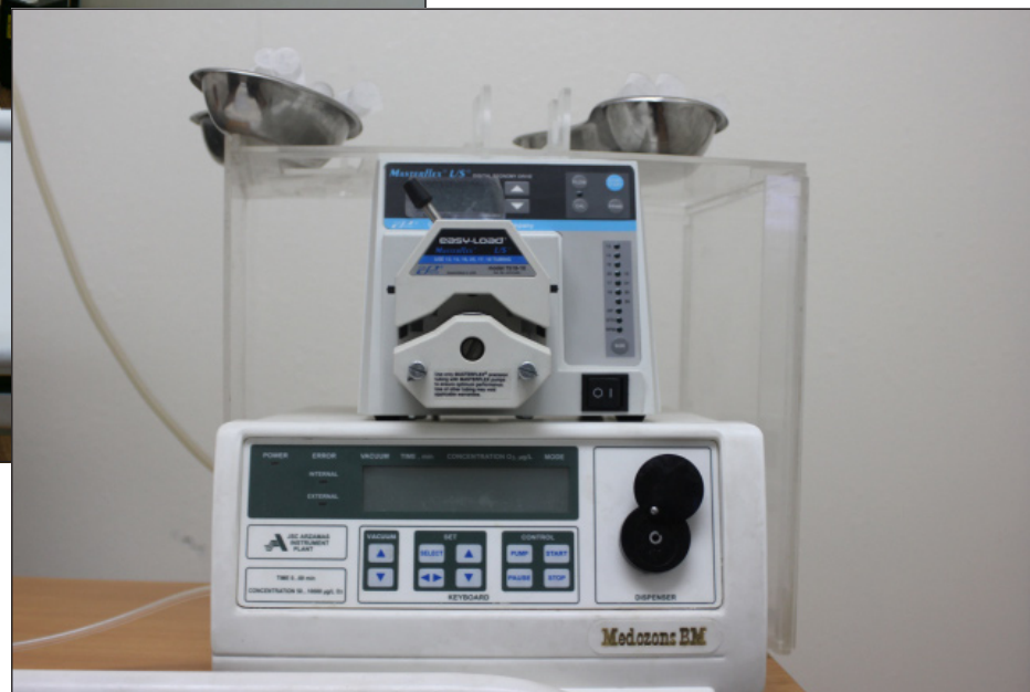
This machine converts the pure oxygen (O 2 ) to ozone gas (O 3 ).
