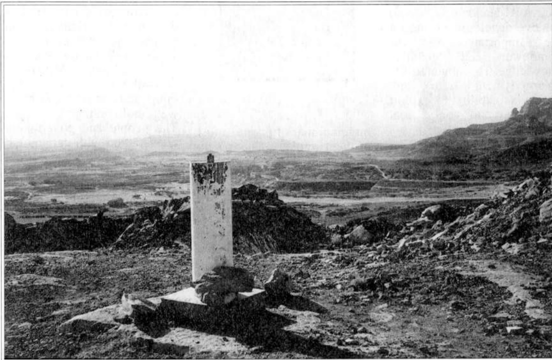
Une borne géodésique sur la route entre Sanaa et Mareb. Il y en a 236 comme celle-là dans le nord du Yémen.
